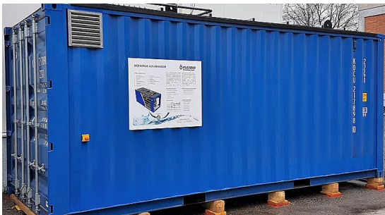
Abwasser aus dem HTC-Prozess (Schweiz Chur) ca. 15 m 3 /d (Indirekteinleitung), Anlagentyp AF-050
