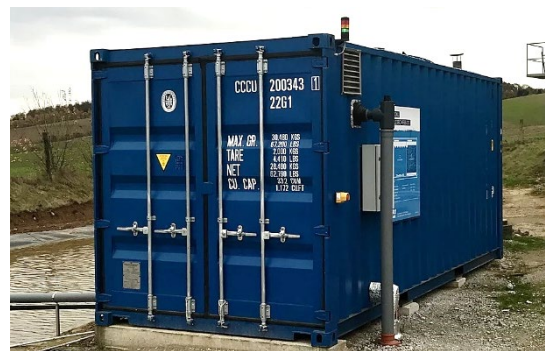
Sickerwasser aus Abfallbehandlung (China, Tianjin) ca. 5 m 3 /d (Direkteinleitung), Anlagentyp AFBBM-100
